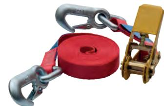
**Sangle d'arrimage de 25 mm type 2-01152-2** (EN12195-2) à boucle de serrage galvanisée (01152). Sangle en polypropylène, 25 mm de large, jaune, thermofixée à allongement faible. Pour sécuriser les vélos et les motos. Avec des crochets en S caoutchoutés des deux côtés, protège la charge des rayures.
