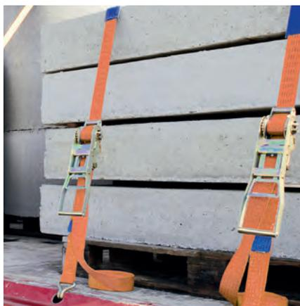
**Sangle d'arrimage de 50 mm de type ZE50 avec cliquet** (EN12195-2) en acier à haute résistance, promatisé (20060). Sangle en 100% polyester, 50 mm de large, orange, thermofixée à allongement faible. Crochet d'arrimage innovant à linguet. Idéal pour l'arrimage. Une force de prétension plus élevée de 750 daN peut être vérifiée via le TFI optionnel.
