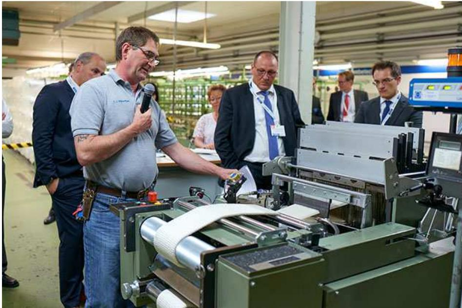
*Abb.3: Berthold Grundmann zeigt die Herstellung von NoCut-Schnittschutzschläuchen aus Hochleistungsfasern in der eigenen Weberei.*
