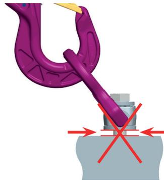
Fig. 8 : L'anneau de levage doit être entièrement vissé.
