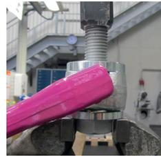
Fig. 12 : Placement de l'ACP pour le démontage de la vis
