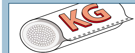
Indicazione della portata in rilievo
