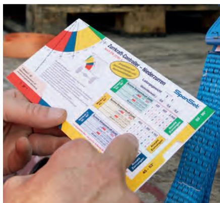
Le contrôleur de force d'arrimage est un outil de calcul du nombre nécessaire d'équipements d'arrimage. Il vous permet de résoudre simplement de nombreuses situations standards dans les opérations quotidiennes d'arrimage. La procédure à observer pour le calcul est décrite.
