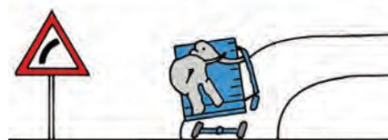
**Lorsque vous changez de direction;** virages, ronds points etc., le coefficient de frottement n'est pas suffisant pour éviter à une charge non arrimée, de glisser dans différentes directions.
