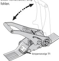
Bei Druckratschen wird das Gurtband durch Hochdrücken und bei Zugratschen (z. B. ErgoABS) durch Herunterdrücken des Spannhebels gespannt.
