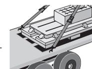
Bei der Verwendung von SpanSet Grip-S sollte ein kleiner Überstand sichtbar sein, um den Nachweis der Verwendung einer rutschhemmenden Unterlage zu erbringen.
