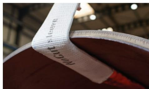
SpanSet NoCut® sleeve – der textile Schutzschlauch.
