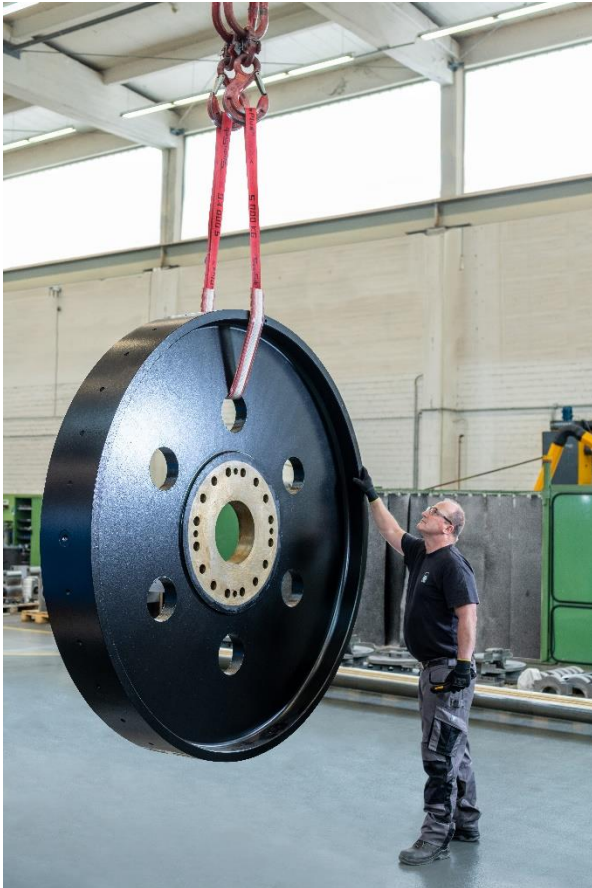
Abb.1: SupraPlus-X mit neuen Pluspunkten: zum Beispiel verstärkte Rippen in der Schlauchhülle und deutlichere Kennzeichnung der Nenntragfähigkeit.
