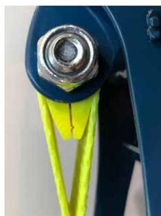
Anzeige bis zur ersten Markierung gespannt. Eingeleitete Vorspannkraft beträgt 750 daN.
