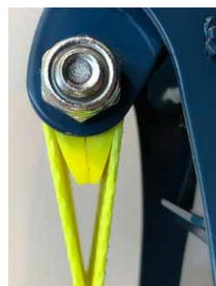
Beide Schenkel liegen aneinander, die Auswölbung liegt in der Vertiefung. Im Gurtband ist eine Vorspannkraft von 1000 daN eingeleitet.
