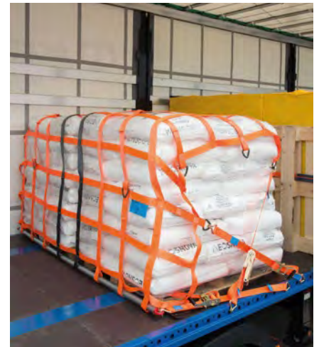
Netz mit Kopflashing
