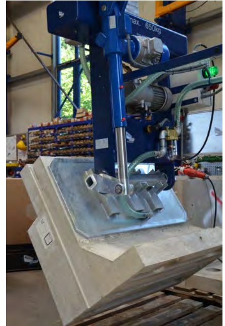
Kundenspezifischer AERO-LIFT Vakuumheber zur Entnahme und 360°-Drehung von Beton-Fertigteilen (L-Steinen)
