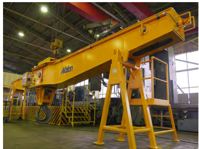
2-Krantraverse mit elektrisch drehbarem Lasthaken 40t
