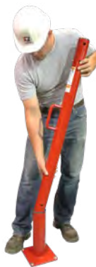
Am Einsatzort wird der Kranmast einfach in die vorhandene Masthalterung (Standfuß ...) geschoben.
