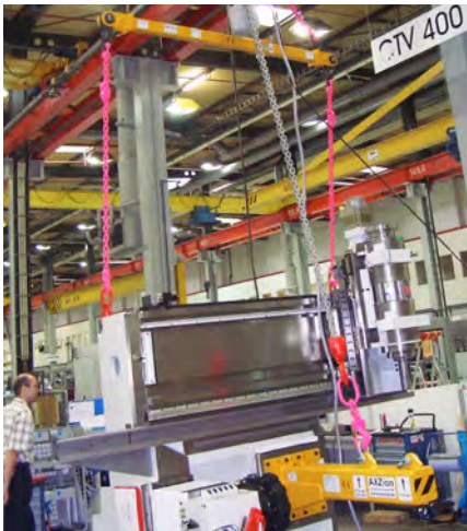
Spreiztraverse Mit Hubzug zur Einstellung der Lastneigung
