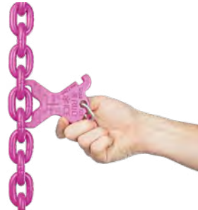
Prüfung der plastischen Längung durch Überlast
