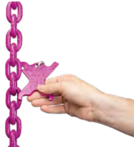
Verschleißprüfung der Nennstärke
