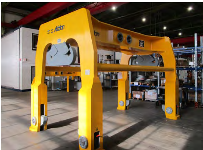
Greifertraverse für Stützwalzen 95t
