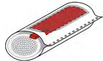
Ausreißfestes Label mit RFID-Transponder
