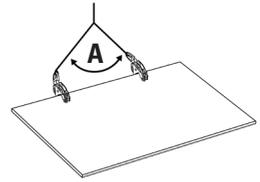
ES **Inspeccione los ángulos de la carga**
