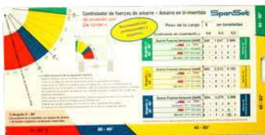
Le contrôleur de forces de SpanSet est un outil qui permet de calculer sommairement le nombre de dispositifs nécessaires pour arrimer la charge en sécurité ou de choisir les moyens d'arrimage les plus appropriés pour la charge à transporter.
