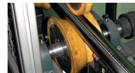
Rulli guida e rulli pressori con anima intercambiabile
