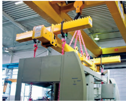
63-t-H-Traverse für Maschinen-transporte
