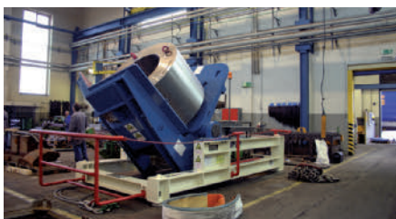
Bild: 80-t-Wendeeinheit für U-Boot Sektion
