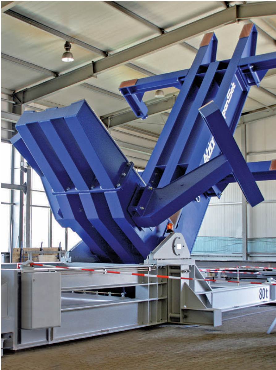
Bild: 80-t-Wendeeinheit für U-Boot Sektion
