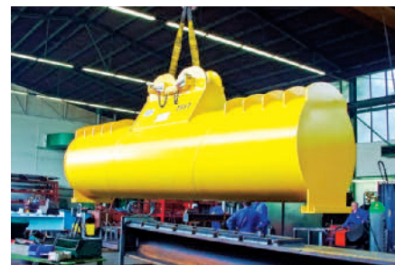
155-t-Rohrtraverse für Schwerlast-rundschlingen
