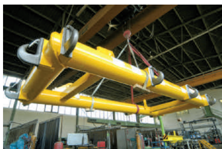
110-t-Rahmentraverse für Container
