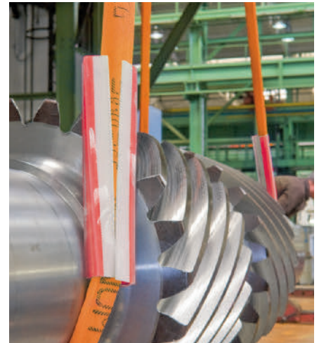
secutex-Schutzschlauch Clip-SC: Einseitige secutex-Beschichtung, hinten offener Schlauch für flexiblen Einsatz.
