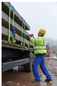
Abb. 2: Niederzurren: Das Material wird auf die Ladefläche gepresst.
