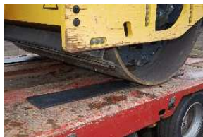
Abb. 3: Antirutschmatten erhöhen die Reibung zwischen Ladefläche und Ladegut. Damit sinkt der Bedarf an Zurrmitteln.
