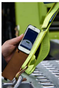
Abb. 4: Bestimmung des Zurrwinkels mit der kostenlosen Zurr-Rechner-App von SpanSet.
