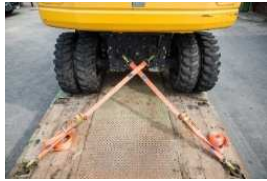
Abb. 1: Schwere Maschinen werden in der Regel diagonal verzurrt.
