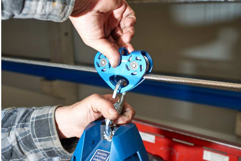
Abb. 5: Das Höhengsicherungs-Gerät wird in einen Rollenläufer eingehängt.
