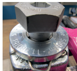
Abb. 14: Sprengring umlaufend vertieft in der Ansenkung positioniert
