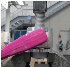
Abb. 12: Auflage des ACP zur Demontage der Schraube
