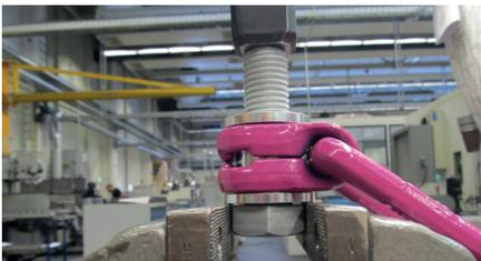
Image 7 : Support du VLBG pour le démontage de la vis
